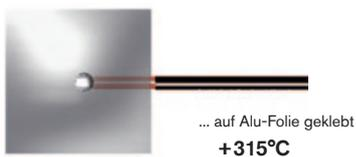
■ Besonders geeignet, wo schnell und unkompliziert Temperaturen gemessen werden müssen. Vorteil: keine besondere Vorbereitung an den zu messenden Stellen notwendig. Einzig und alleine sollte darauf geachtet werden, dass der Untergrund möglichst frei von Staub, Fett und Ölen ist.
