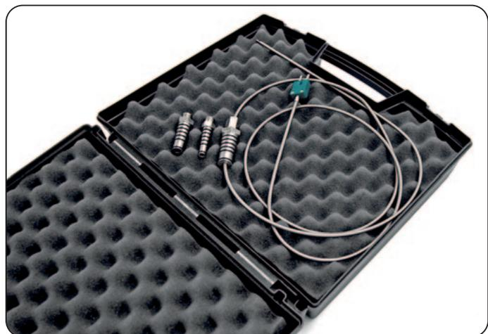
Peilstab-Thermoelement mit Dichteinsätzen wird in einem Koffer geliefert.
